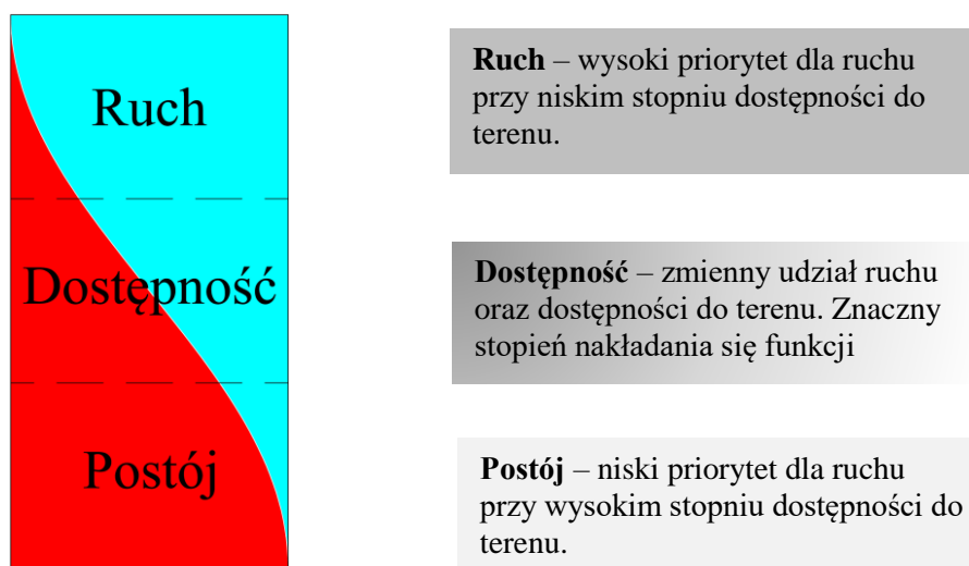
Rys. 2. Zmiana funkcji drogi zależna od charakteru ruchu i dostępności do terenu oraz nakładanie się funkcji szczegółowych wg FHWA
